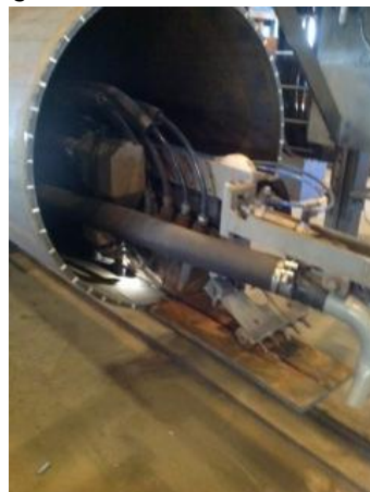
Fig.2 Impianto per saldatura longitudinale dei tubi
